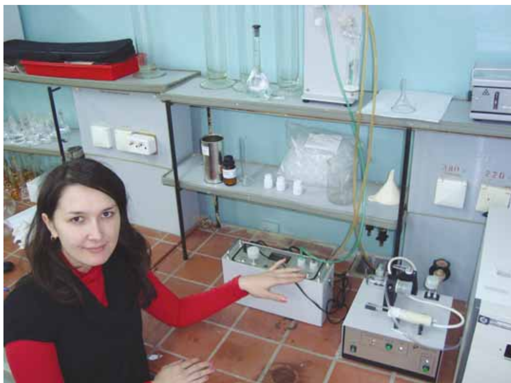
Аспирант А. Динмухаметова анализирует содержание ртути в пробах почвы на универсальном ртутном комплексе УКР-1 МЦ
